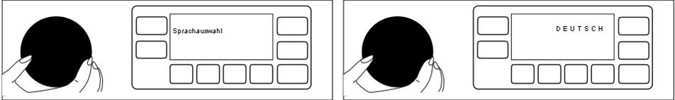
2. Drehen Sie den **Programmauswahl** knopf, bis die gewünschte Sprache im Sprache wählen-Menü am Display angezeigt wird.
