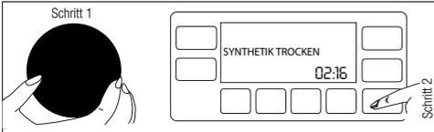
Mit diesem Programm trocknen Sie nasse oder feuchte Synthetikwäsche, deren Trockengewicht 4 kg entspricht. Dieses Programm führt nur eine Trocknung durch.
