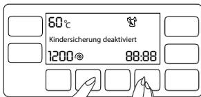
Halten Sie die **2. und 4. Zusatzfunktionstaste** 3 Sekunden lang gedrückt. Nach Ablauf des Countdowns („Kindersicherung 3-2-1“) im Display wird „Kindersicherung deaktiviert“ angezeigt.
