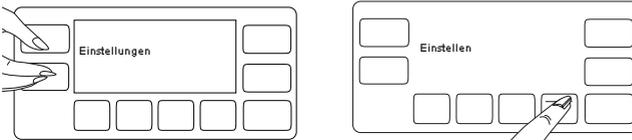
1. Halten Sie zum Aufrufen des Einstellungsmenüs 3 Sekunden **Temperatur einstellaste** und **Schleudergeschwindigkeit-Einstelltaste** gedrückt. Öffnen Sie mit der Trocknungstaste das „Helligkeit“-Menü.
