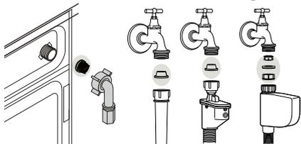
Am Endstück jedes Wasserzulauffentils an der Rückseite der Maschine sowie am Ende der Wasserzulauffschläuche (dort, wo diese an den Wasserhahn angeschlossen werden) befindet sich ein Filter. Diese Filter verhindern, dass Fremdkörper und Schmutz mit dem Wasser in die Waschmaschine gelangen. Die Filter sollten bei Verschmutzung gereinigt werden.
