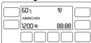
Das Programm wird abgebrochen, wenn die Maschine aus- und wieder eingeschaltet wird. Halten Sie die **Ein-/Austaste** 3 Sekunden gedrückt. Nach Ablauf des Countdowns „Abbrechen 3-2-1“ im Display schaltet sich die Maschine aus.
